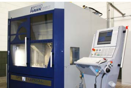
▼ Speed Hawk - 3- und 5-Achsverarbeitung in einer Maschine
