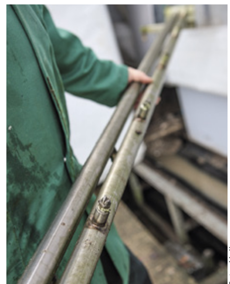
Düsenleiste am Kotschieber: So können die Spalten auch von unten gesäubert werden.
